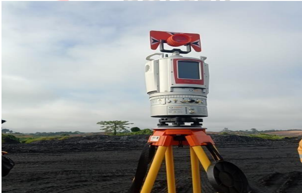
Gambar 2. 2 Terrestrial Laser Scanner Vz-2000i yang digunakan dalam tugas akhir
