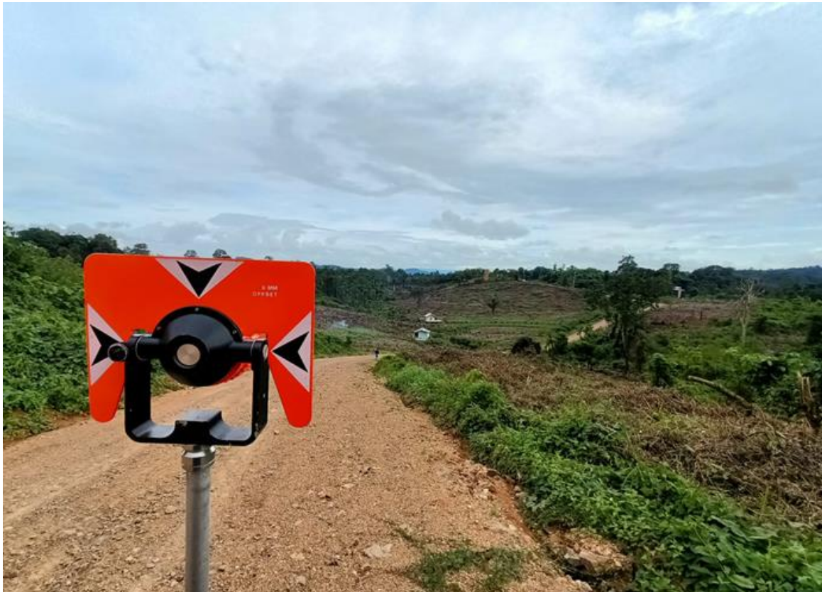
Gambar 2.2.1 Pengukuran survei topografi langsung di lokasi penelitian
