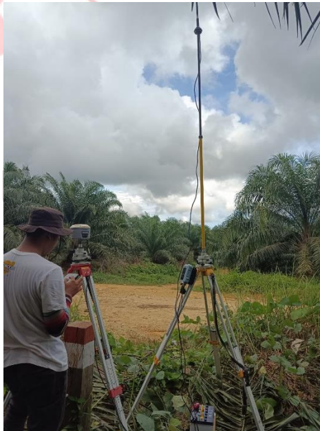
Lampiran 1. 3 Proses mendirikan Base RTK Radio
