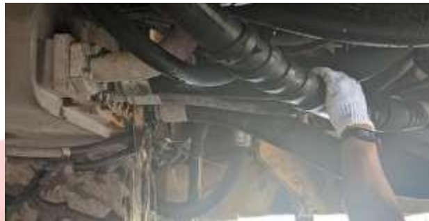
Gambar 2. 9 Proses Replace Hose (Haerul Fauzan, 2025. Dokumentasi Pribadi)
