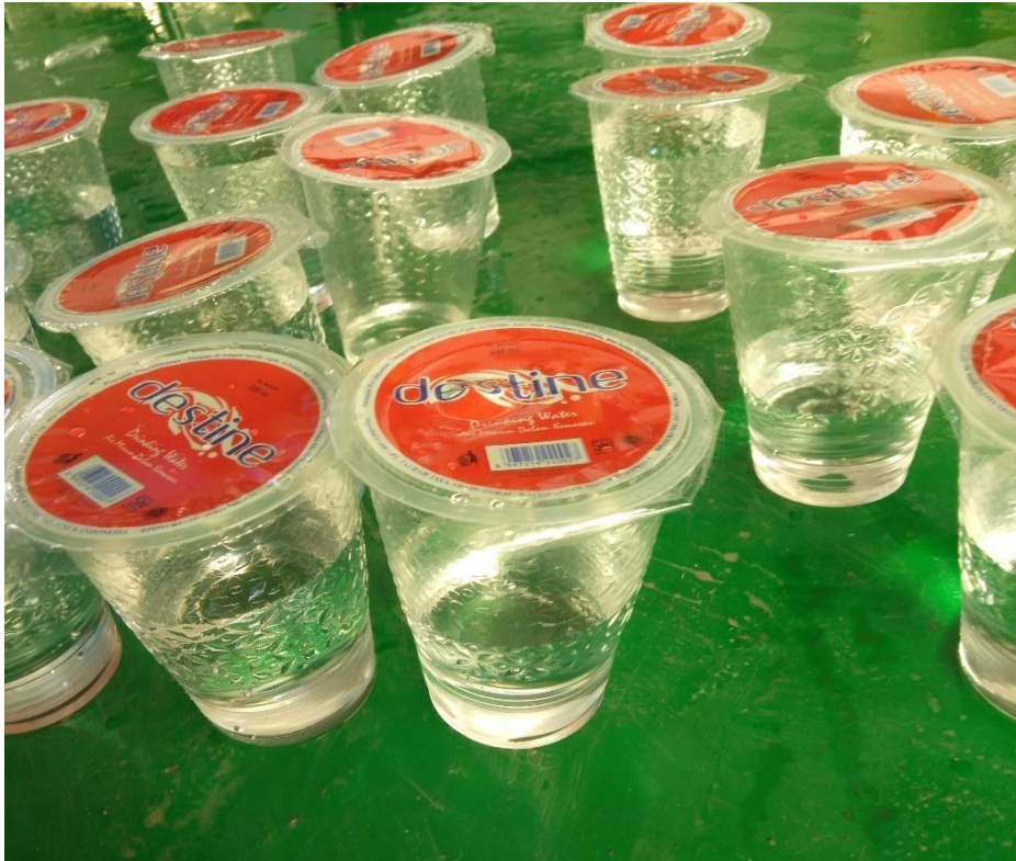
Lampiran 8 Cacat Lid Bocor pada Produk Cup 220 ml
