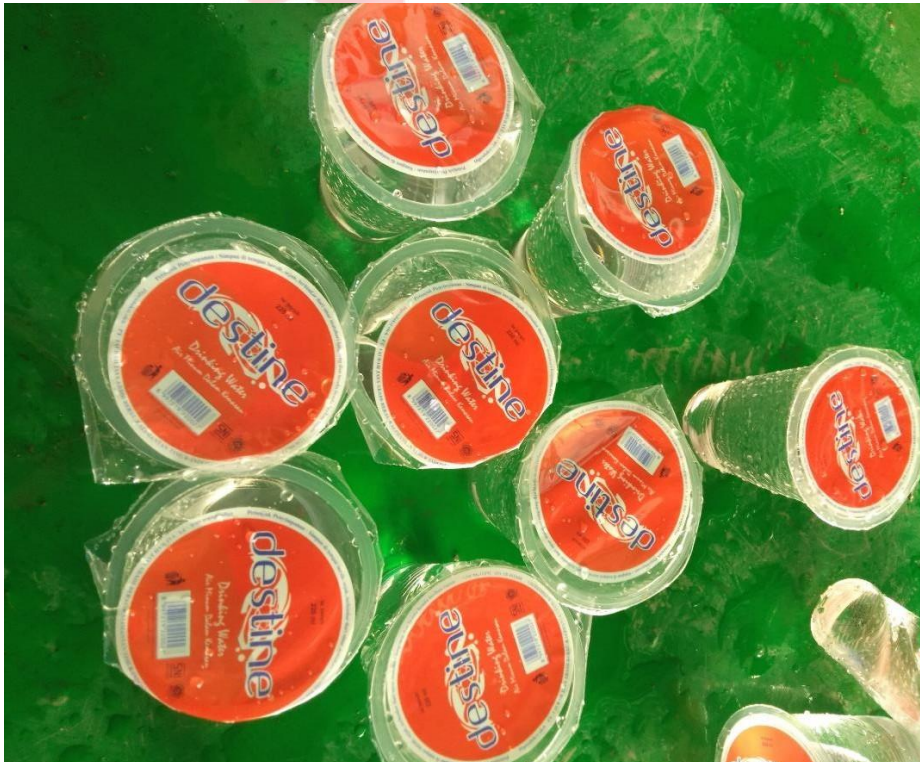
Lampiran 8 Cacat Lid Bocor pada Produk Cup 220 ml
