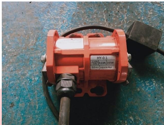
Gambar 2. 4 Motor Vibrator ( Sumber : Dokumentasi Pribadi, 2022 )
