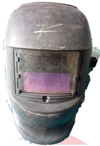
Gambar 3. 22 Helm Las ( Sumber : Dokumentasi Pribadi, 2022 )
