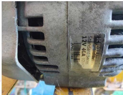
Gambar 2.7 Alternator (Sumber. Dokumentasi Pribadi)
