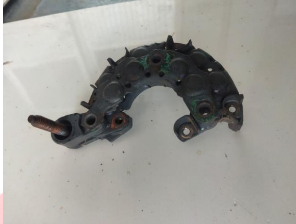
Gambar 2.9 Dioda (Sumber. Dokumentasi pribadi)
