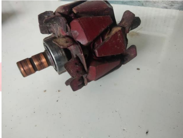
Gambar 2.11 Rotor Dan Kumparan Rotor (Sumber. Dokumentasi Pribadi)
