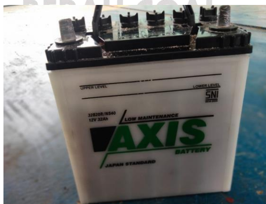
Gambar 2.3 Baterai (Sumber, Dokumentasi Pribadi)
