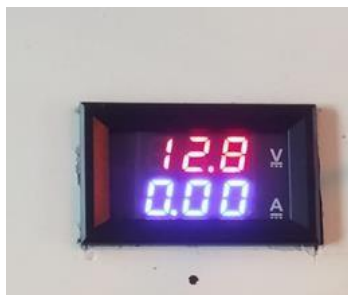
Gambar 2.20 Volt Meter (Sumber, Dokumentasi Pribadi)
