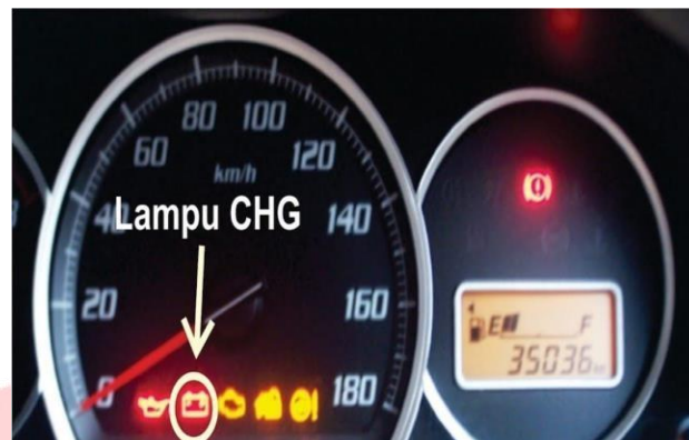
Gambar 2.4 Lampu Indikator Pada Dashboard Kendaraan
