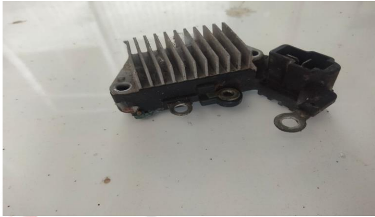
Gambar 2.8 IC Regulator (Sumber. Dokumentasi Pribadi)
