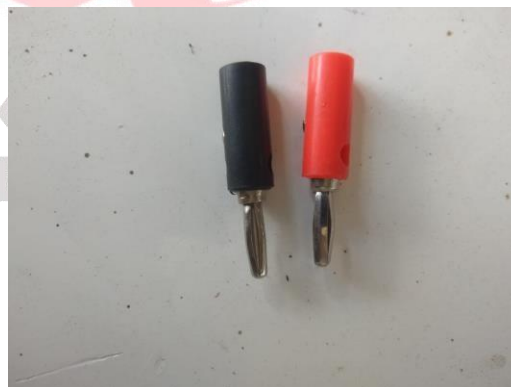
Gambar 2.25 Banana Jack Male 4 mm (Sumber, Dokumentasi Pribadi)
