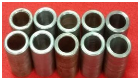
Gambar 2. 2 Bushing Crusher (Dok pribadi, 2023)
