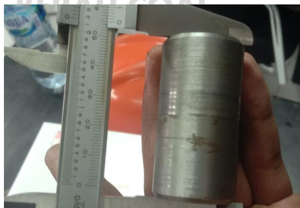
Gambar 2. 6 Panjang bushing tidak sesuai ukuran
