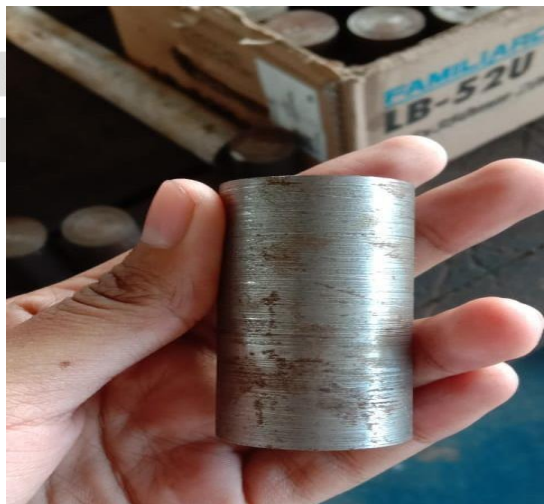
Gambar 2. 8 Permukaan bushing kasar
