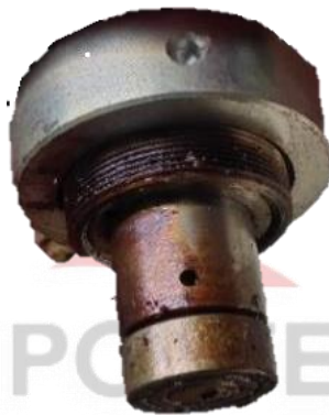
Gambar 2.4 Slide (Ram) Sumber : Dokumentasi Pribadi (2022)
