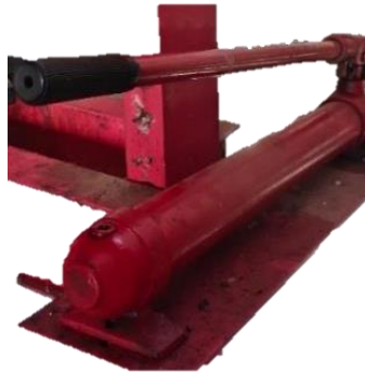
Gambar 2.2 Pompa Hidrolik Manual Sumber : Dokumentasi Pribadi (2022)
