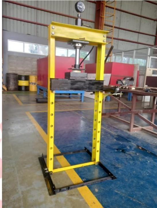
Lampiran 11 Kondisi Mesin Press Yang Sudah Selesai Di Rakit
