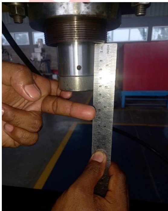
Lampiran 12 Pengukuran Panjang Stroke Piston Ram Mesin Press
