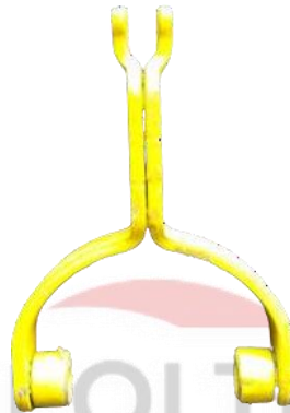
Gambar 2.12 Drive lever (Sumber: Dokumentasi pribadi. 2022)
