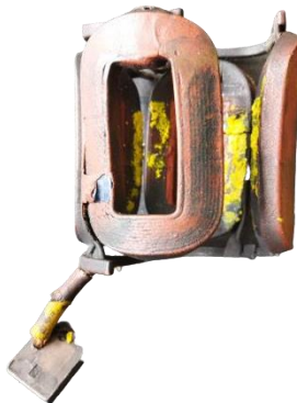
Gambar 2.6 Field coil (Sumber: Dokumentasi pribadi. 2022)
