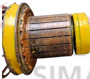
Gambar 2.8 komutator (Sumber: Dokumentasi pribadi. 2022)
