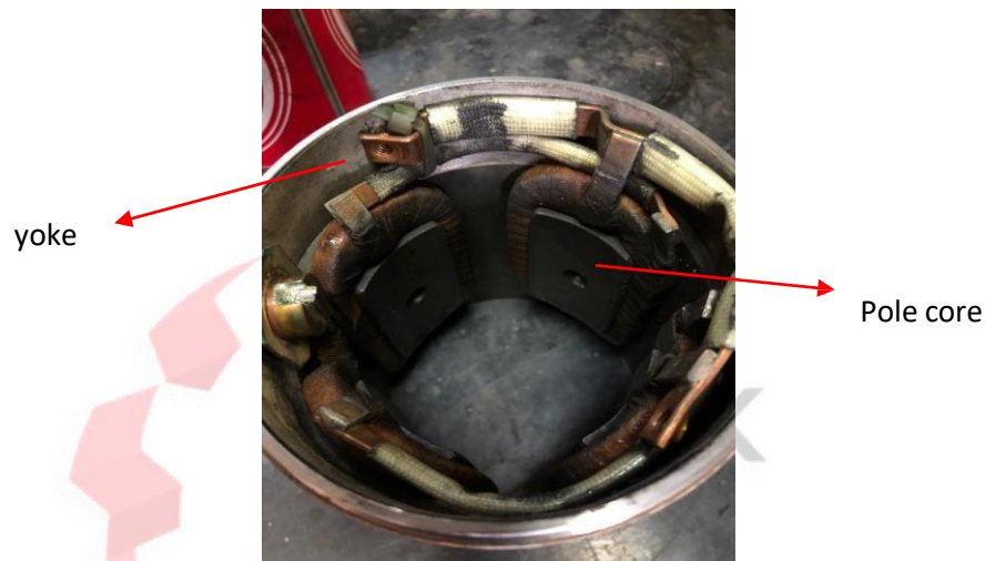
Gambar 2.5 Yoke & Pole Core (Sumber: Dokumentasi pribadi. 2022)
