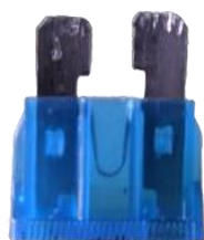
Gambar 2.14 Fuse (sekring) (Sumber: Dokumentasi pribadi. 2022)
