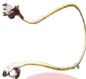
Gambar 3.9 Kabel seri battery (Sumber: Dokumen pribadi. 2022)
