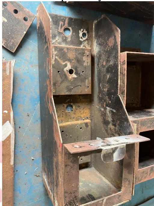
Lampiran 5 Hasil perakitan seluruh komponen menjadi satu unit LOTO Box
