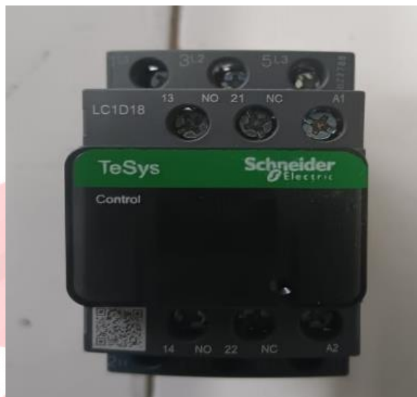
Gambar 2. 9 Contactor (Otniel, 2024. Dokumentasi pribadi)
