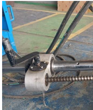
Gambar 2. 5 Feeder line boring (Sumber. Dokumentasi pribadi)
