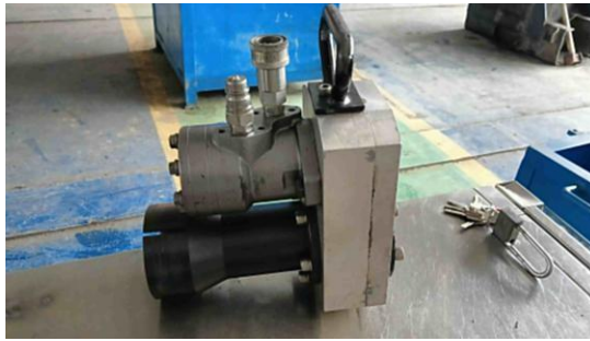
Gambar 2. 7 Motor hidrolik (Sumber. Dokumentasi pribadi)
