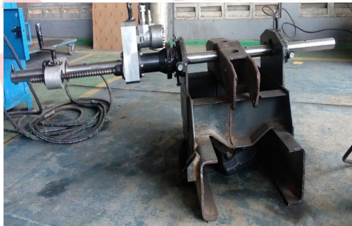
Gambar 2. 2 Mesin line boring hidrolik (Sumber. Dokumentasi pribadi)
