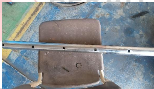
Gambar 2. 4 Shaft line boring (Sumber. Dokumentasi pribadi)
