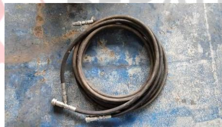
Gambar 2. 10 Hose line boring (Sumber. Dokumentasi pribadi)
