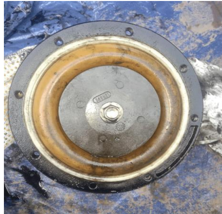
Gambar 2. 6 Membran (Sumber: Dokumentasi Pribadi)
