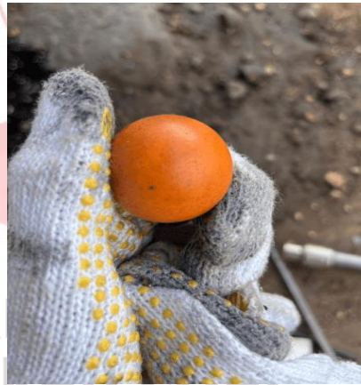
Gambar 2. 7 Check Valve Ball (Sumber: Dokumentasi Pribadi)
