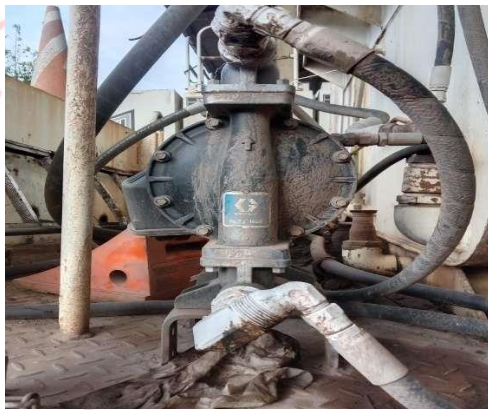
Gambar 2. 5 Pompa Diafragma (Sumber: Dokumentasi Pribadi)
