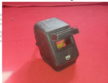
Gambar 3.17 Helm Las (Sumber. Dokumentasi Pribadi)
