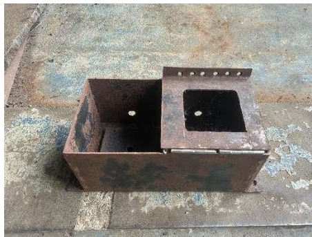
Gambar 2.14 Box Loto Emergency (Sumber Dokumentasi Pribadi, Hadi, 2025)
