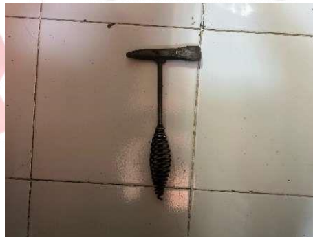
Gambar 3.7 Hammer Chipping (Sumber Dokumentasi Pribadi, Hadi, 2025)
