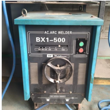
Gambar 2. 2 Mesin las SMAW Sumber : Dokumentasi pribadi (2022)
