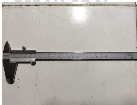
Gambar 3. 3 Vernier caliper/jangka sorong Sumber : dokumentasi pribadi (2022)
