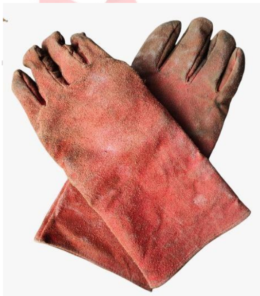
Gambar 3. 17 Sarung tangan las Sumber : dokumentasi pribadi (2022)
