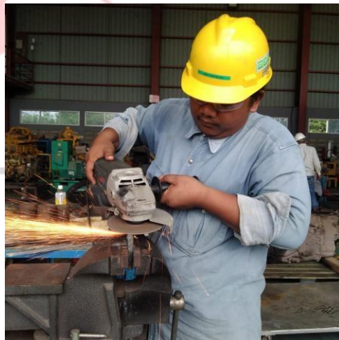
Proses meratakan permukaan benda uji
