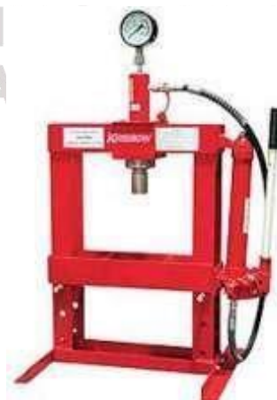
Gambar 2.20 Mesin Press Menggunakan Tenaga Hidrolik (Sumber : http://repository.umsu.ac.id/handle/123456789/1328 )
