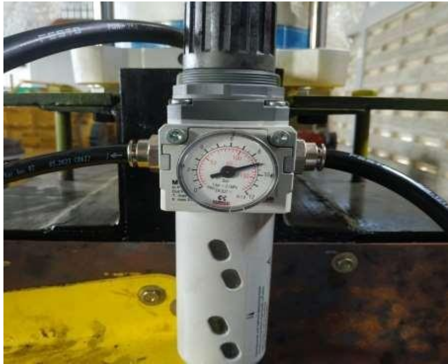
Gambar 3. 21 Tekanan pada regulator sebesar 9 bar (Dokumentasi pribadi, 2022)
