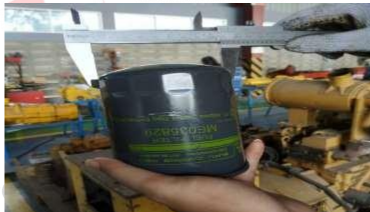
Gambar 3. 16 Pengukuran diameter limbah fuel filter (Dokumentasi pribadi, 2022)
