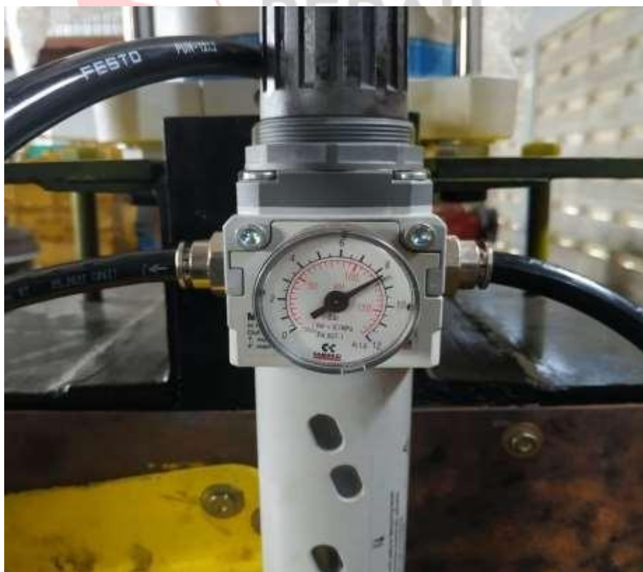
Gambar 3. 20 Tekanan pada regulator sebesar 8,5 bar (Dokumentasi pribadi, 2022)
