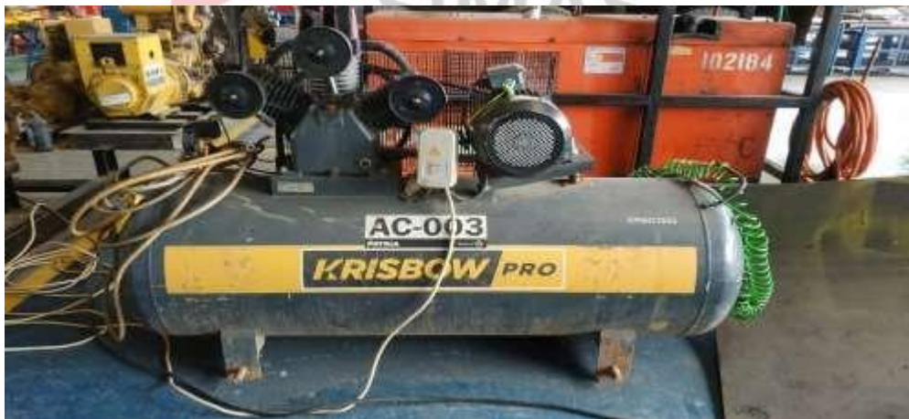
Gambar 3. 14 Kompresor (Dokumentasi pribadi, 2022)
