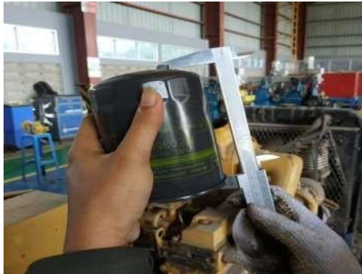
Gambar 3. 17 Pengukuran ketinggian limbah fuel filter (Dokumentasi pribadi, 2022)
