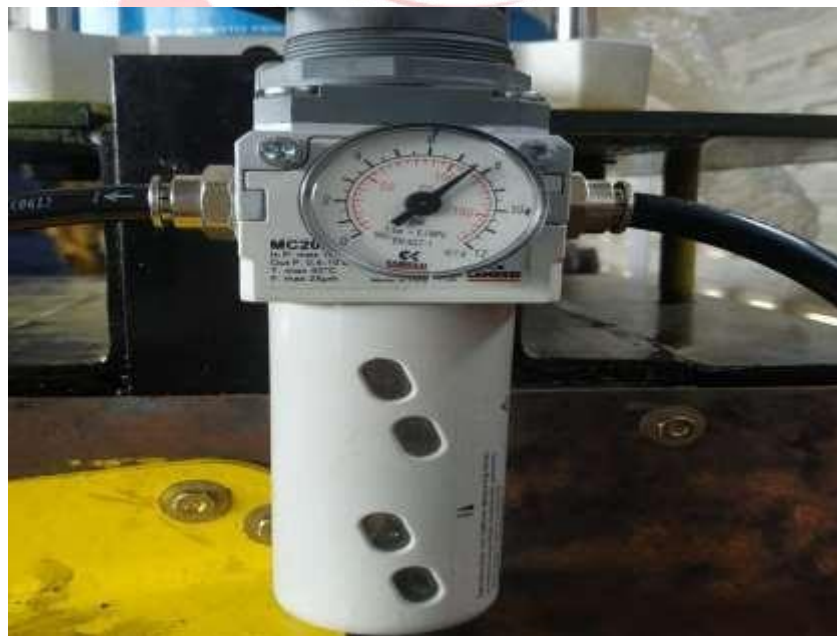
Gambar 3. 18 Tekanan pada regulator sebesar 7,5 bar (Dokumentasi pribadi, 2022)
