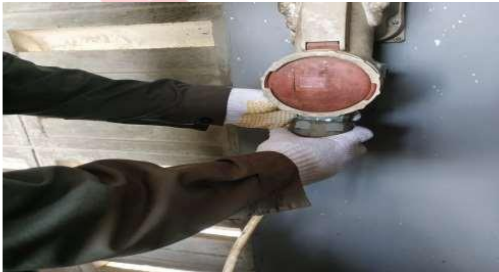
Lampiran 1. 2 Memasang kabel kompresor ke sumber daya listrik atau colokan
