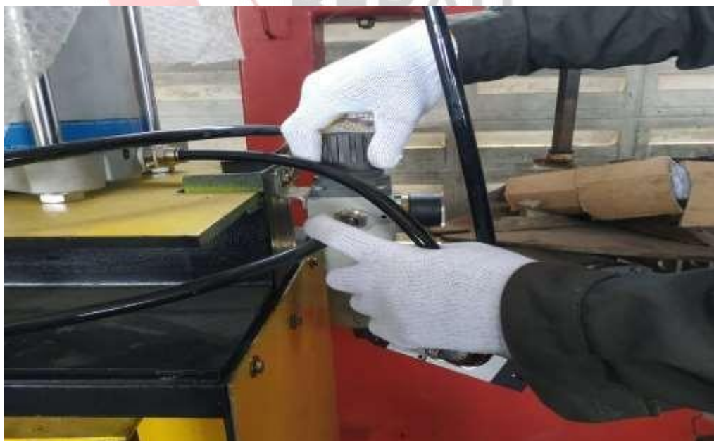
Lampiran 1. 6 Mengatur tekanan pada mesin press
