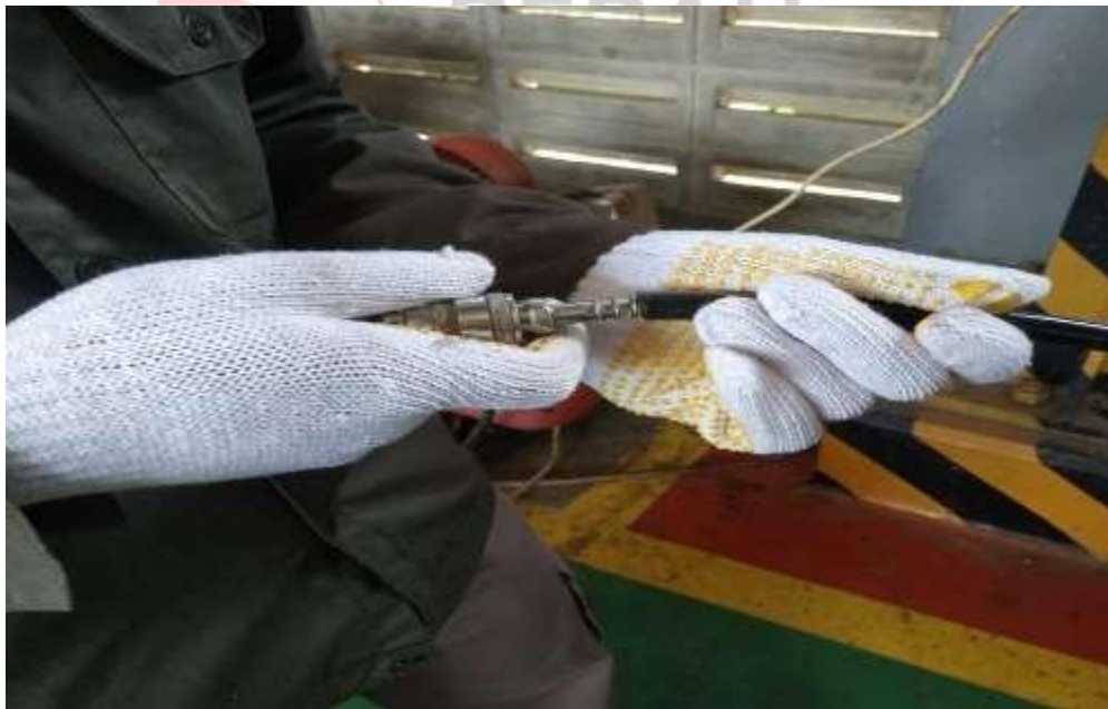
Lampiran 1. 4 Pemasangan konektor dari hose kompresor ke hose mesin press
