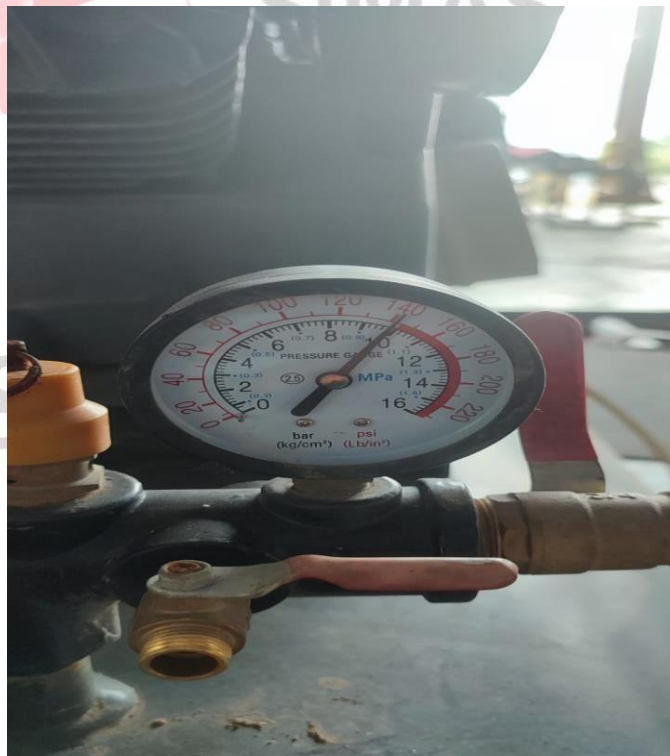
Tekanan pada kompresor (10 bar)
