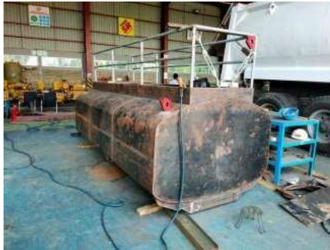
Tangki yang dibuat menggunakan plat roll machine
