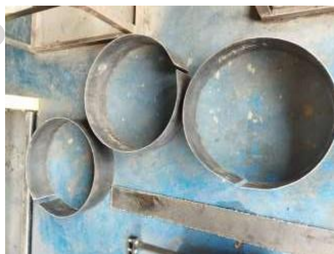
Tapak roda gerobak yang di bending menggunakan plat roll machine
