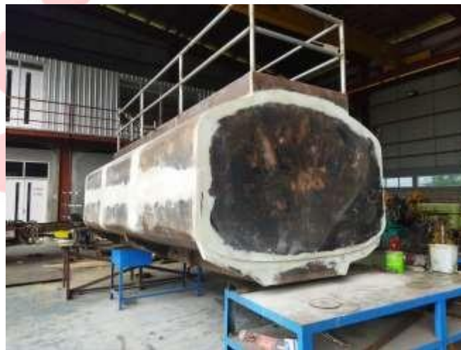
Tangki yang dibuat menggunakan plat roll machine
