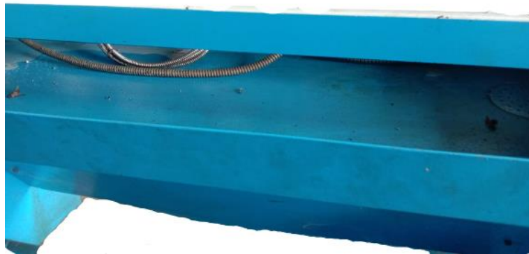
Gambar 2.16 Oil Tray / Nampan Minyak. Sumber : Dokumentasi Pribadi (2022)
