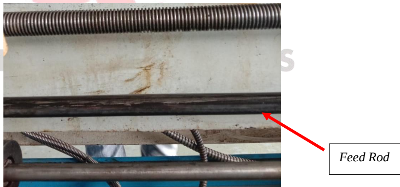
Gambar 2.7 Feed Rod / Poros Berjalan Sumber : Dokumentasi Pribadi (2022)
