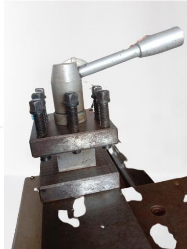
Gambar 2.4 Tool post / Tempat Pahat Sumber Foto : Dokumen Pribadi (2022)
