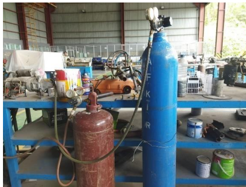
Gambar 3. 14 Las Oxygen Acetylene (Sumber: Dokumentasi pribadi)
