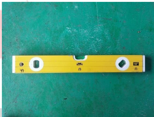
Gambar 3. 15 waterpass (Sumber: Dokumentasi pribadi)
