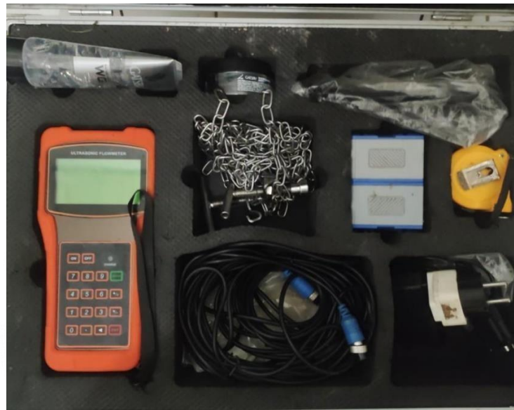
Gambar 3.2 Ultrasonic Flow Meter Sumber, Dokumentasi Pribadi
