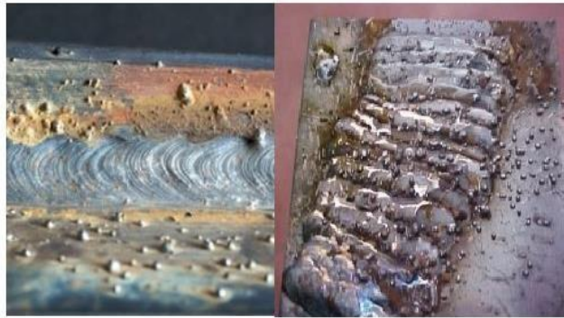
Gambar 2.8 Cacat Las Over Spatter
