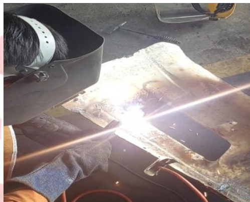
Gambar 2.4 Posisi Pengelasan di bawah Tangan Sumber : Dokumentasi pribadi 2023
