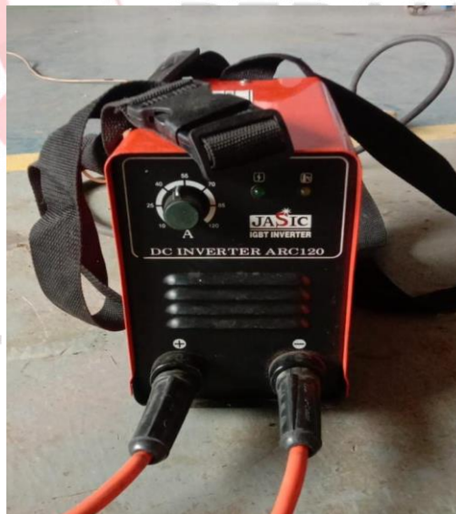
Gambar 2.2 Mesin las Smaw Sumber : Dokumentasi pribadi (2023)
