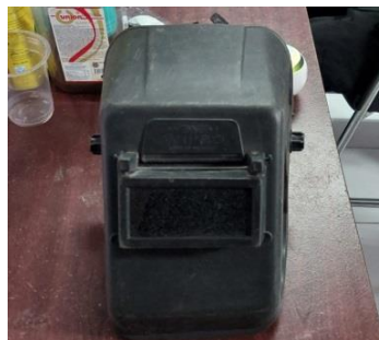
Gambar 3.22 Helm las Sumber : Dokumentasi pribadi (2023)
