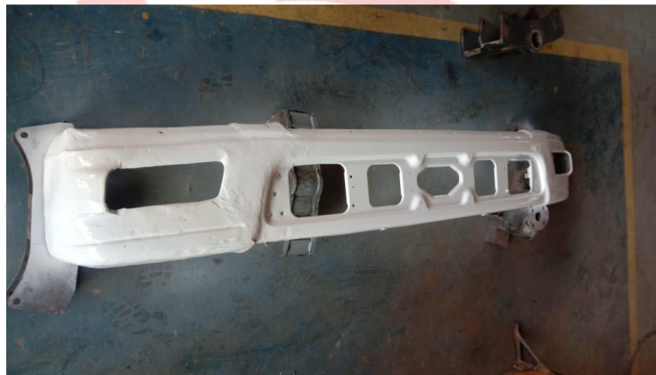
Bumper setelah di spray gun tampak sisi kiri
