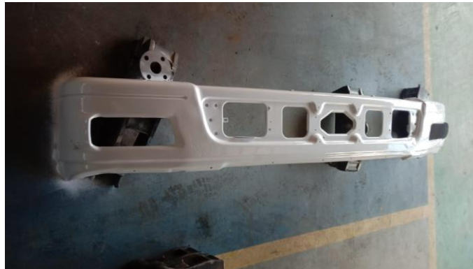
Bumper setelah di spray gun tampak sisi kanan
