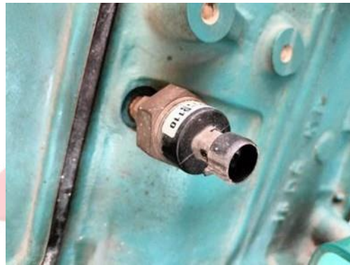
Gambar 2.7 Sensor Tekanan Oli (Sumber:Dokumentasi Pribadi)
