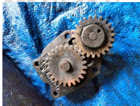
Gambar 2.4 Pompa Oli (Sumber: Dokumentasi Pribadi)
