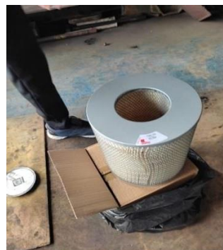
Gambar 2.19 Air Filter Sumber: Dokumentasi Pribadi 2023
