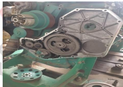
Gambar 2.24 Pompa Oli Sumber: Dokumentasi Pribadi 2023
