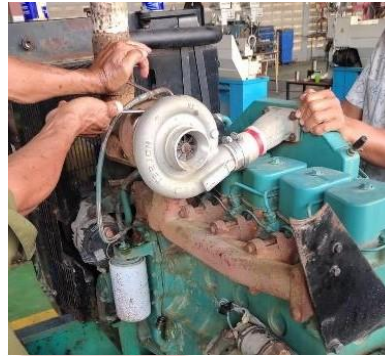
Gambar 2.20 Turbocharger Sumber: Dokumentasi Pribadi 2023
