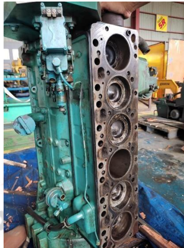
Gambar 2.18 Cylinder Block Sumber: Dokumentasi Pribadi 2023
