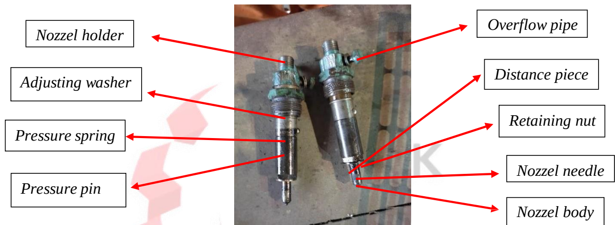
Gambar 2.14 Injektor Sumber: Dokumentasi Pribadi 2023
