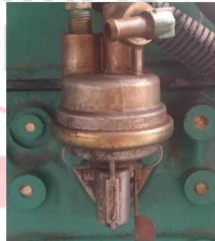
Gambar 2.16 Feed Pump Sumber: Dokumentasi Pribadi 2023
