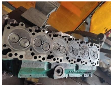
Gambar 2.17 Cylinder Head Sumber: Dokumentasi Pribadi 2023
