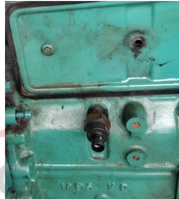
Gambar 2.27 Sensor Tekanan Oli Sumber: Dokumentasi Pribadi 2023
