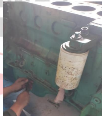
Gambar 2.26 Filter Oli Sumber: Dokumentasi Pribadi 2023
