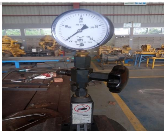
Gambar 3. 9 Injector Nozzle Tester Sumber: Dokumentasi Pribadi
