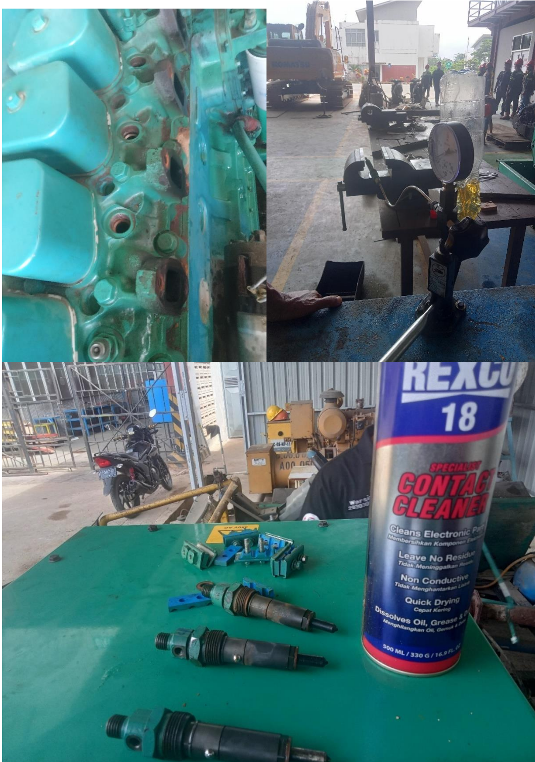
Gambar 22 Dokumentasi pembongkaran, pembersihan dan pengukuran injection pump
