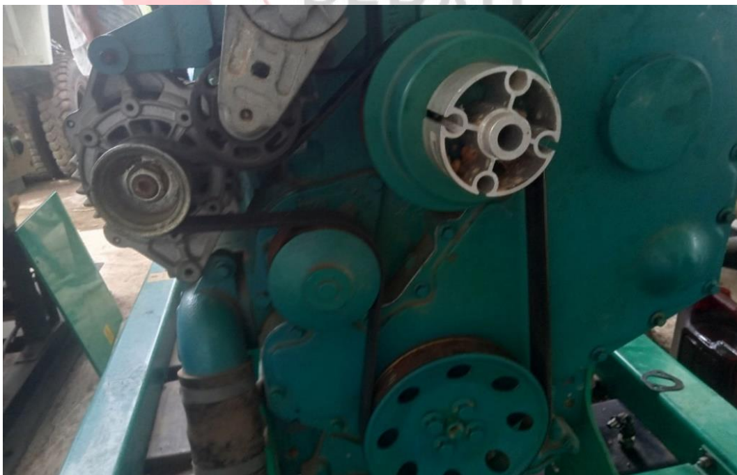
Gambar 21 Dokumentasi Sesudah Pemasangan V-Belt
