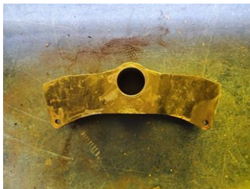
Gambar 2. 4 Suspension spring equalizer . Sumber : dokumentasi pribadi (2023)
