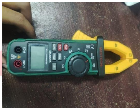
Gambar 2. 5 Amperemeter Sumber : dokumentasi pribadi (2023)
