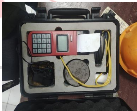
Gambar 2. 3 Portabel hardness tester Sumber : dokumentasi pribadi (2023)
