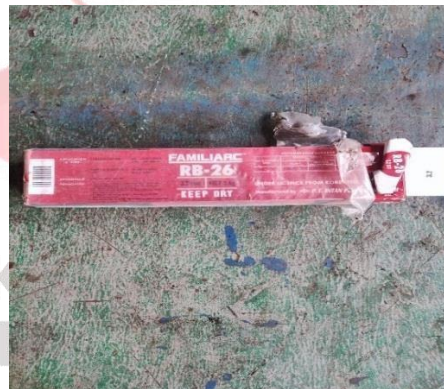
Gambar 3. 8 Kawat las Sumber : dokumentasi pribadi (2023)
