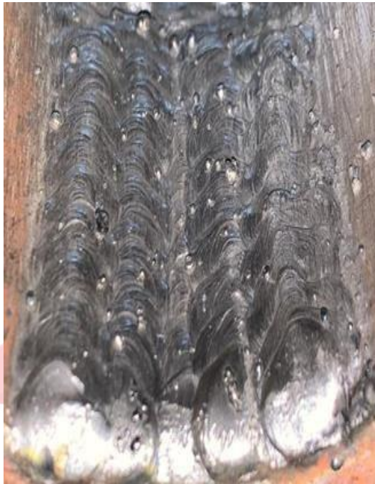
Gambar hasil pengelasan ampere 120
