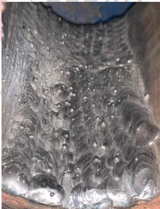
Gambar hasil pengelasan ampere 110
