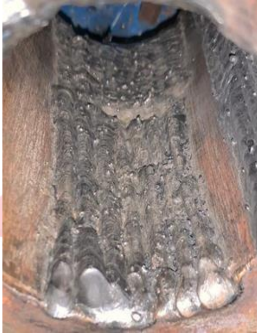
Gambar hasil pengelasan ampere 80
