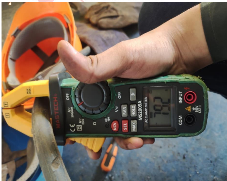
Gambar pengukuran kuat arus 110 A
