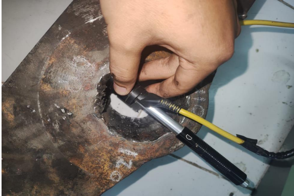
Gambar pengukuran kekerasn 80 A
