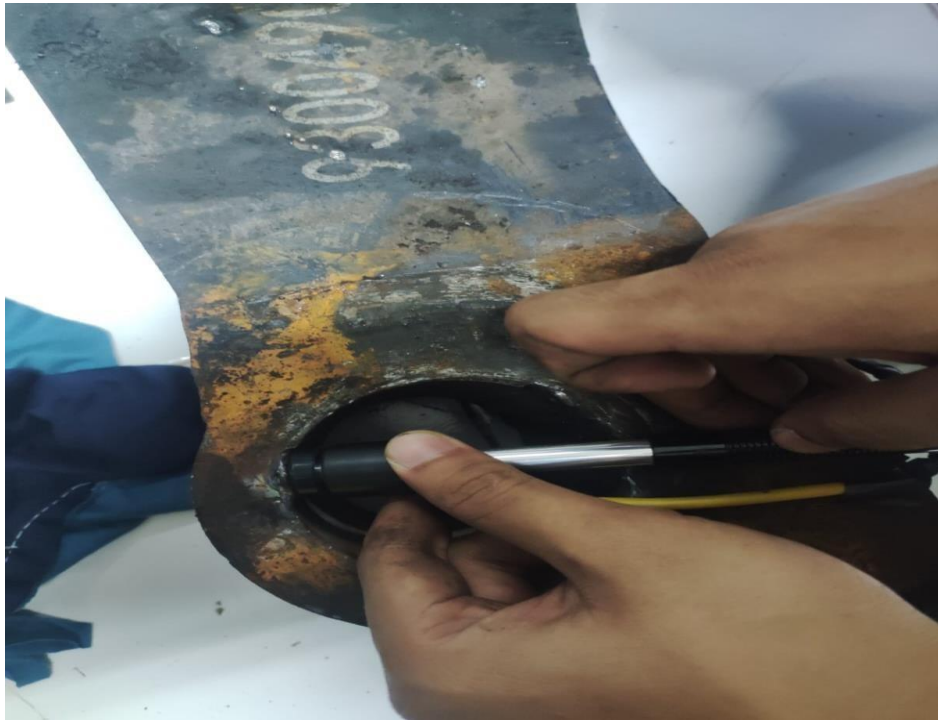
Gambar pengukuran kekerasan 90 A
