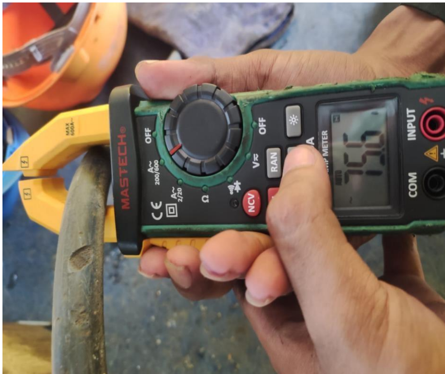
Gambar pengukuran kuat arus 100 A
