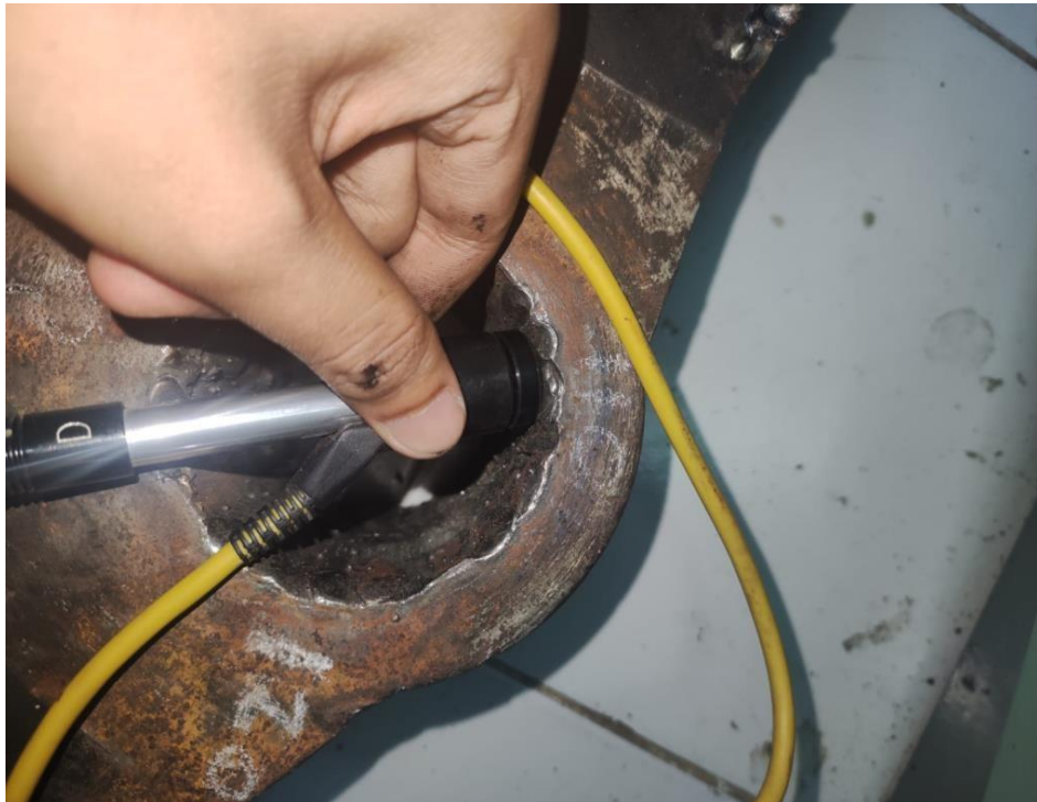
Gambar pengukuran kekerasan 100 A
