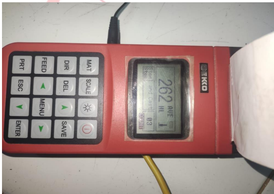
Gambar hasil pengukuran kekerasan 80 A
