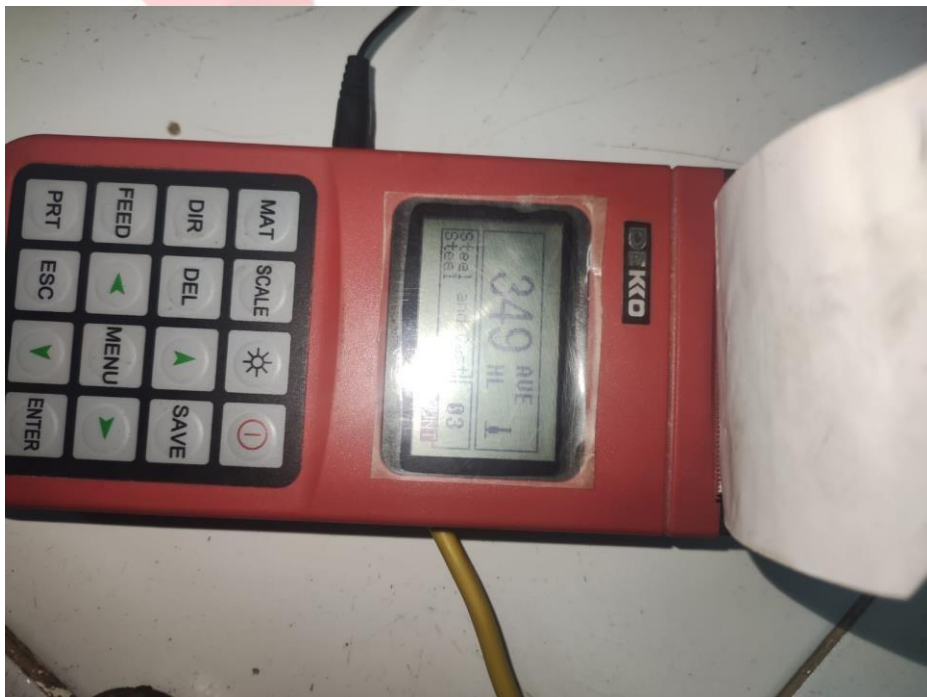
Gambar hasil pengukuran kekerasan 90 A
