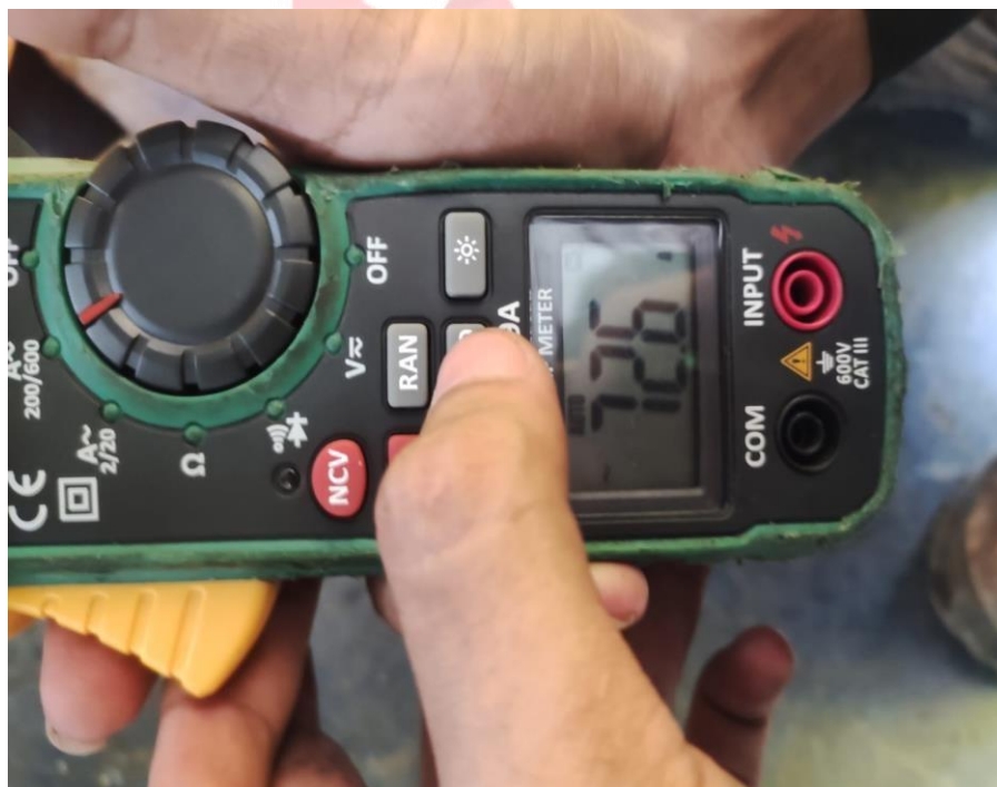
Gambar pengukuran kuat arus 90 A
