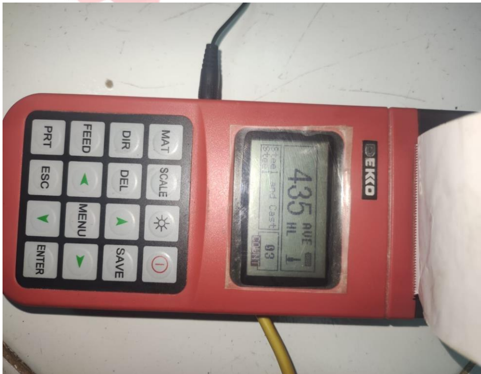
Gambar hasil pengukuran kekerasan 100 A
