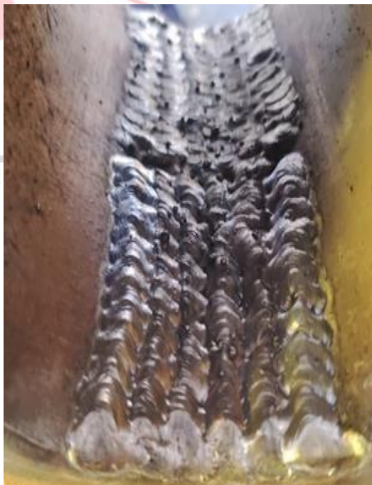
Gambar hasil pengelasan ampere 90
