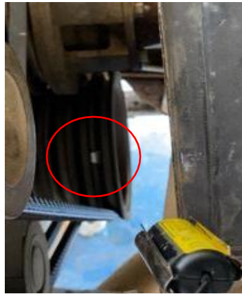
Gambar 3.10 Pemasangan stiker reflektif pada putaran crankshaft (Dokumentasi Pribadi)
