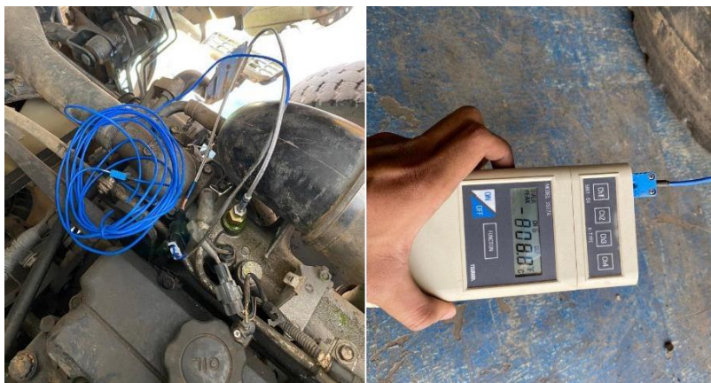
Gambar 3.9 Pemasangan alat thermocouple (Dokumentasi Pribadi)
