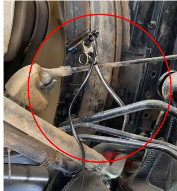
Gambar 3.12 Posisi tachometer setelah selesai terpasang(Dokumentasi Pribadi)
