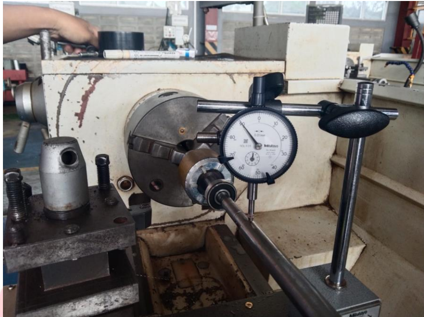
Pengukuran kelurusan shaft
