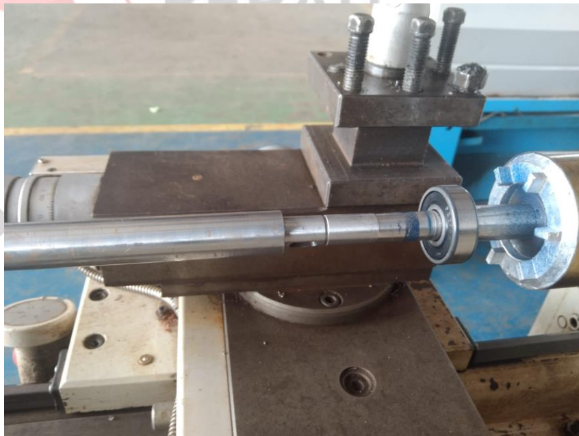
Proses penyambungan shaft
