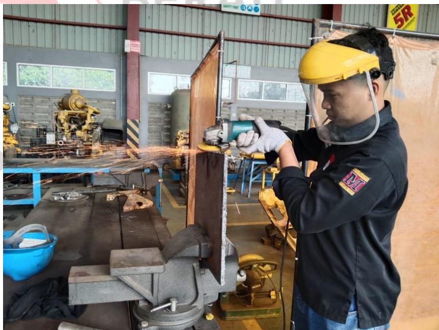
Penggerindaan platudukan mesin
