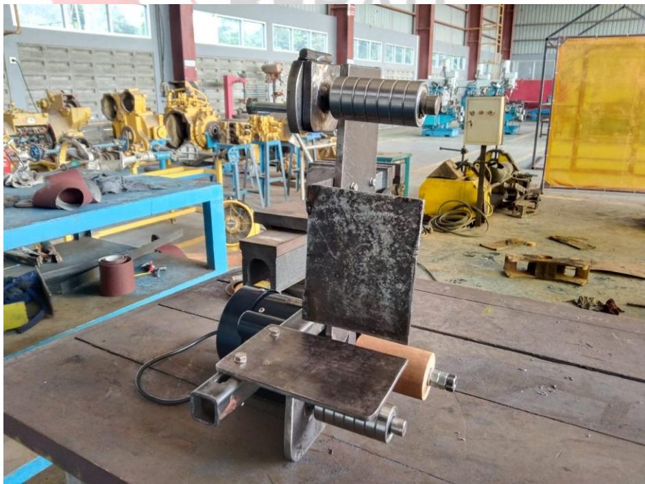
Hasil pemasangan pelindung amplas
