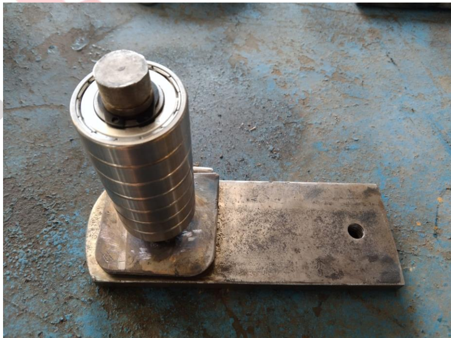
Pemasangan bearing di engsel
