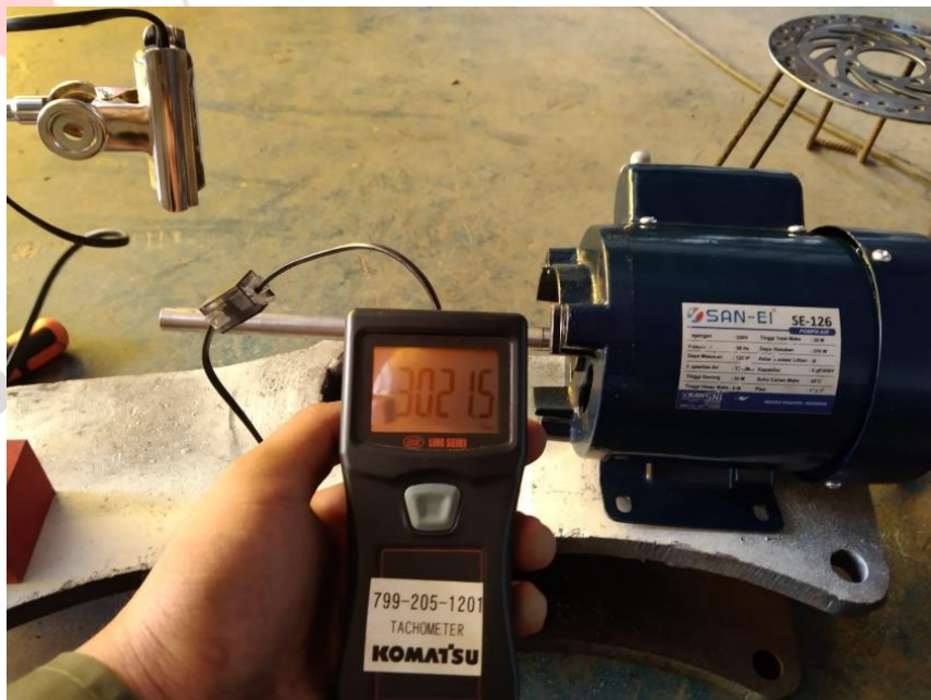
Pengukuran rpm motor listrik
