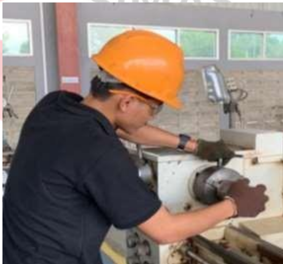
Proses pemasangan benda kerja
