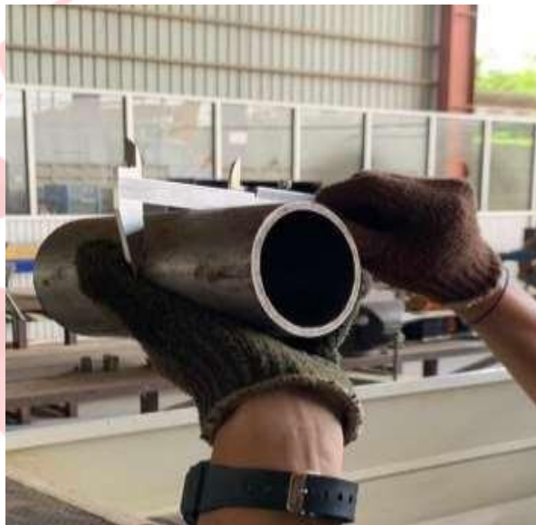
Proses pengukuran hasil pembubutan
