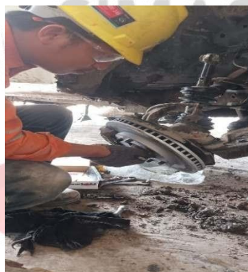
Gambar 2.15 Kerusakan rem cakram Sumber: Foto Pribadi
