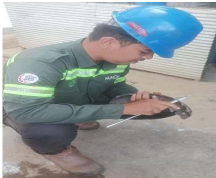
Gambar 1 pengukuran kampas rem
