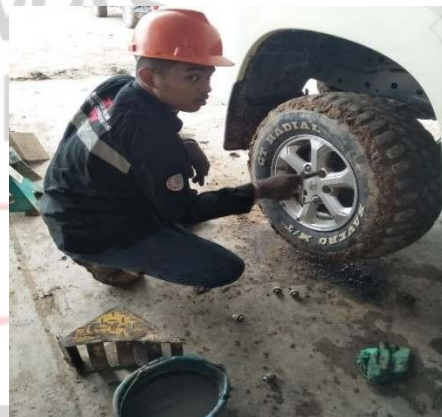
Gambar 4 pengecekan mur roda
