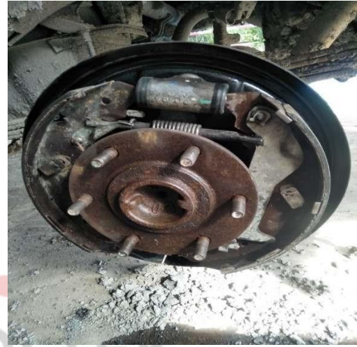
Gambar 16 sampel tromol telah bersih
