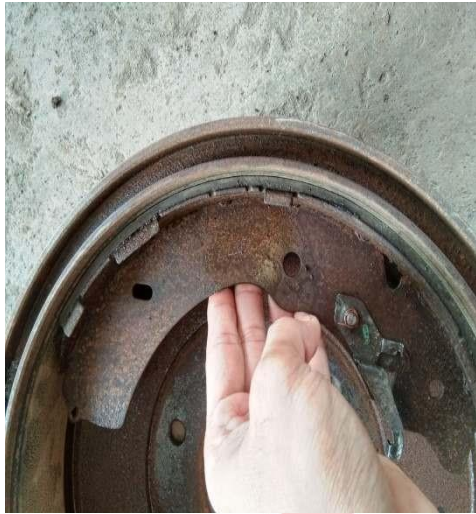
Gambar 19 pengetesan kelayakan drum
