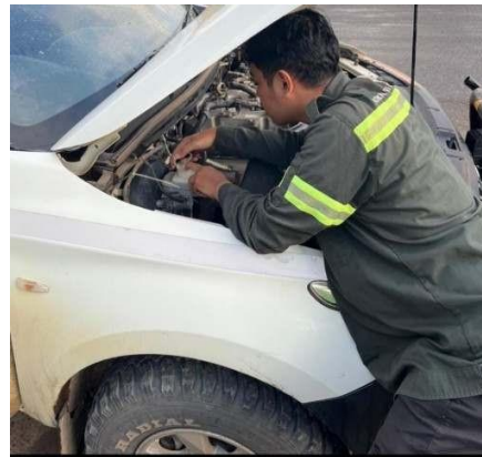
Gambar 6 pengecekan volume oli
