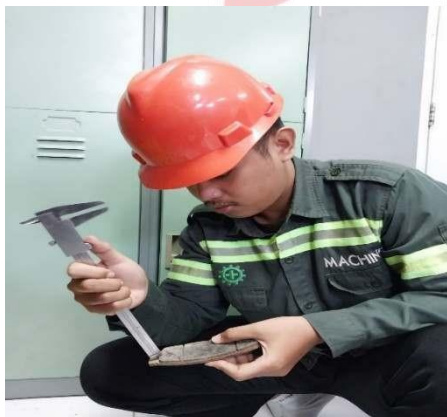
Gambar 3 pengukuran brake pad
