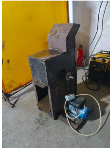
Gambar 3. 2. Mesin Pencacah Plastik (Sumber : Dokumentasi Pribadi)
