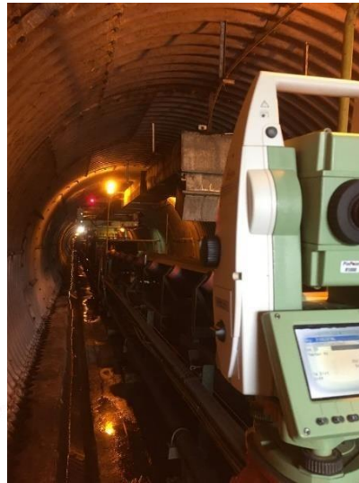
Gambar 2. 4 Contoh pengukuran yang menggunakan Total Station (Foto Penelitian, 2021)
