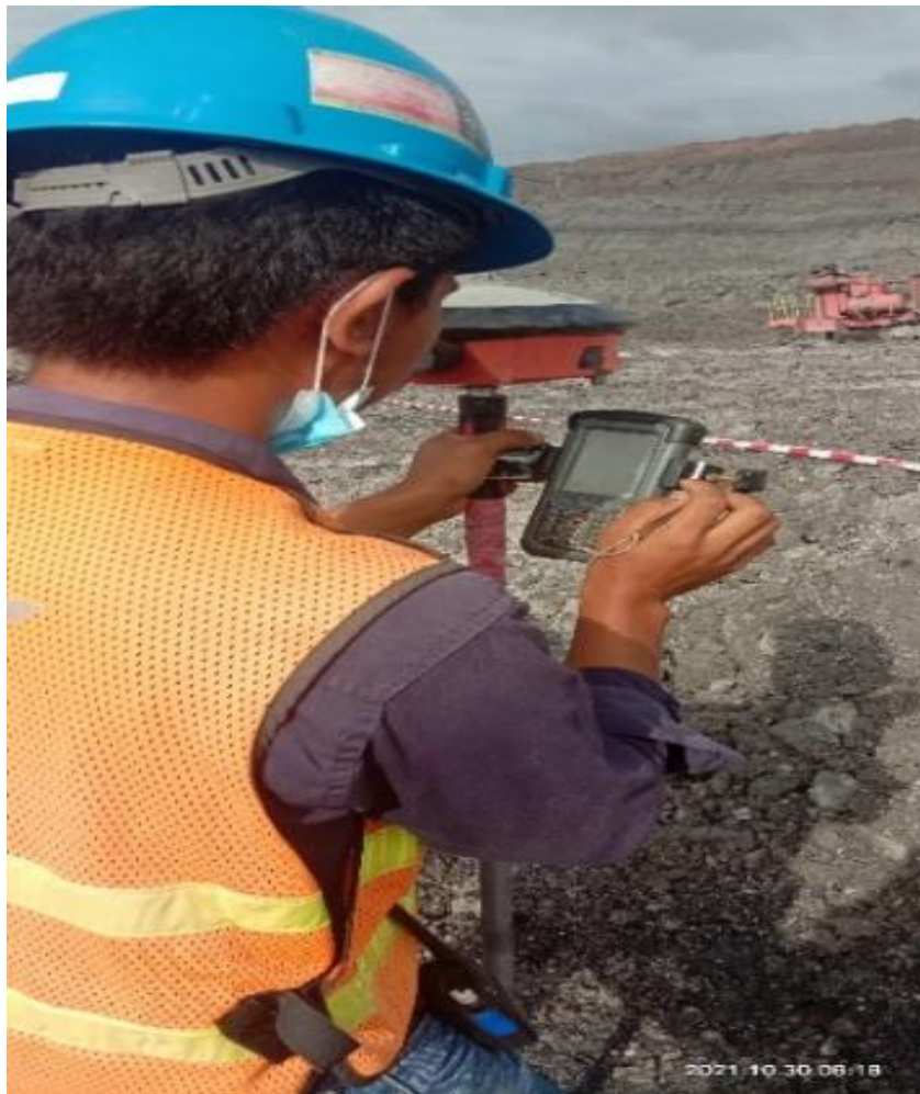
Lampiran 1. 2 Pick Up Lokasi Blasting (Dokumentasi Pribadi Prakerin 2021)
